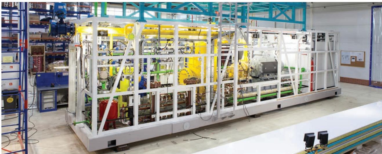
*Дожимная компрессорная станция GEA в процессе изготовления, производственная площадка, г. Климовск*
