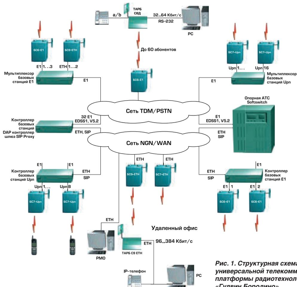
Рис. 1. Структурная схема универсальной телекоммуникационной платформы радиотехнологии DECT «Гудвин Бородино»
