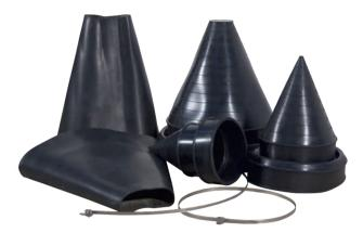
Концевые герметизирующие манжеты ООО «ЭнергоАрм» предназначены для защиты от попадания воды, грунта, грязи и др. в пространство между трубой и футляром. Все модели манжет ООО «ЭнергоАрм» изготавливаются из материалов с высокой механической прочностью, стойкостью к старению и высокой стойкостью к УФизлучению. Материал манжет не токсичен, не выделяет вредных веществ и не проводит электрический ток.
