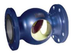
Обратные затворы типа 19с74нж, 19нж74нж с корпусами из трубных заготовок DN 25, 32, 40, 50, 65, 80, 100, 150 на давления PN 16, 25 и 40 кгс/см<sup>2</sup>, материал корпуса Ст.20, 09Г2С и 08Х18Н9Т, для эксплуатации на жидких и газообразных средах.
