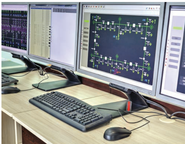
Рис. 3. Пример визуализации SCADA-системы
