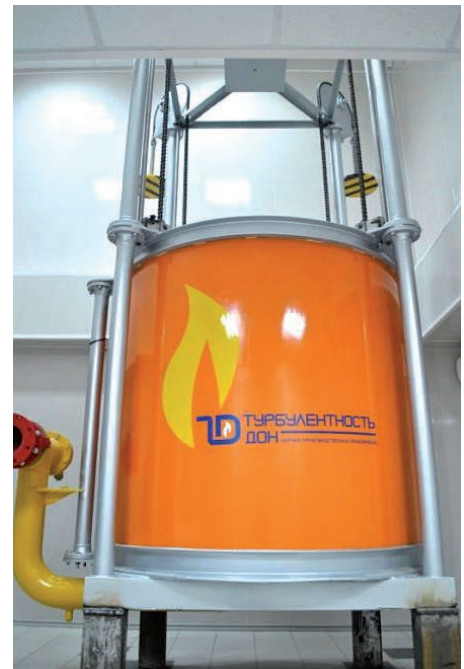
Рис. 6. Колокольная поверочная установка КПУ-2000
