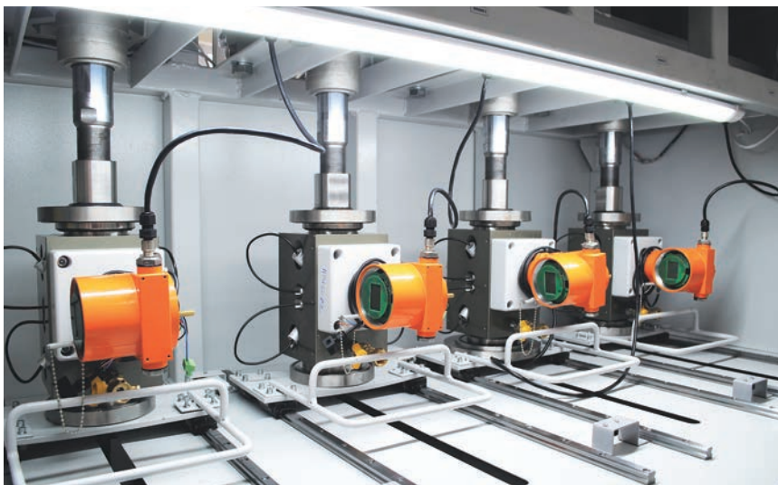
Рис. 11. Стенд проверки герметичности и сухой калибровки ультразвуковых расходомеров газа
