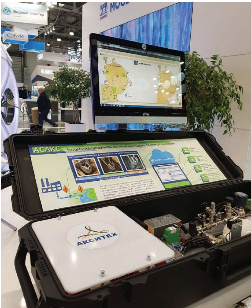
Системы АСАКС успешно эксплуатируются для контроля газо-воздушной среды и состава сточных вод на объектах АО «Мосводоканал»
