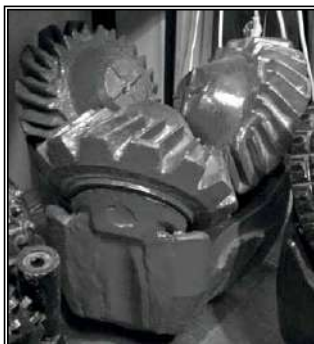
ПИ490С-ЦВР-1М мех. скорость +20% проходка +46%
