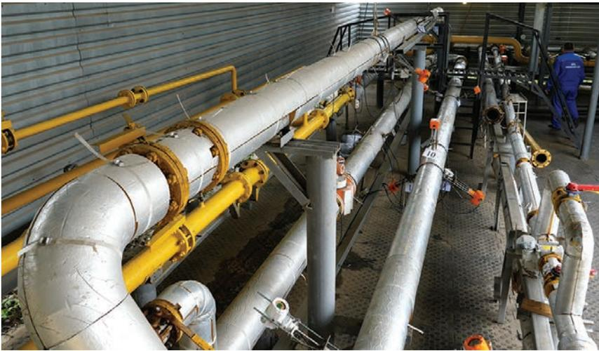
Рис. 2. Эталонная сопловая поверочная установка на природном газе СПУ ПГ-2М, производства ООО НПО «Турбулентность-ДОН»
