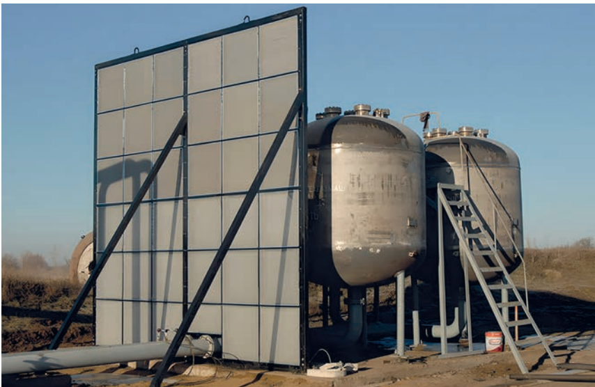
Рис. 2. Общий вид секции водопленочного теплозащитного экрана
