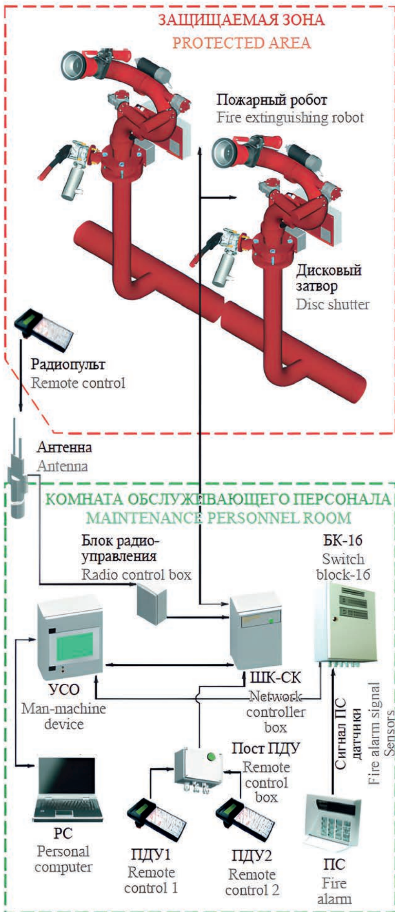
Рис. 4. Принципиальная схема роботизированной установки пожаротушения
