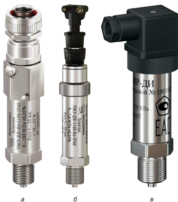
Рис. 5. Датчики давления серии VMP: а – взрывозащищенного исполнения Exd («взрывонепроницаемая оболочка»); б – взрывозащищенного исполнения Exia («искробезопасная электрическая цепь»); в – общепромышленного исполнения
