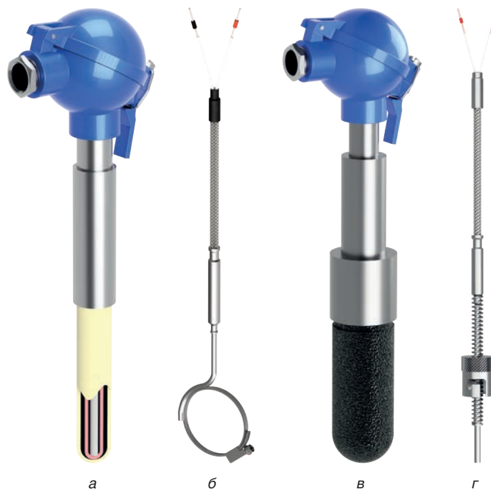
Рис. 1. Внешний вид датчиков температуры НПО «Вакууммаш»: а – термоэлектрический преобразователь ТПП-233, ТПР-233 для высокотемпературных сред; б – кабельный термопреобразователь ТХА-К, ТХК-К, ТЖК, ТНН.301; в – термоэлектрический преобразователь ТПП-234, ТПР-234; г – термопреобразователь сопротивления ТПС 303 Exi
