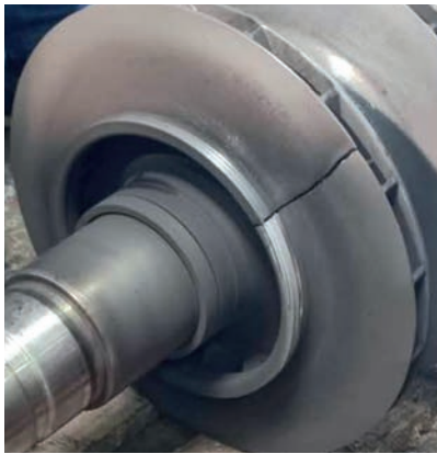
Рис. 9. Разрушение рабочего колеса по узловому диаметру при резонансе
