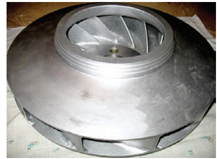
Рис. 6. Стальное рабочее колесо в сварном исполнении
