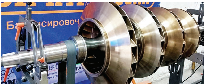
Рис. 2. Стальные рабочие колеса, паяные палладиевым припоем
