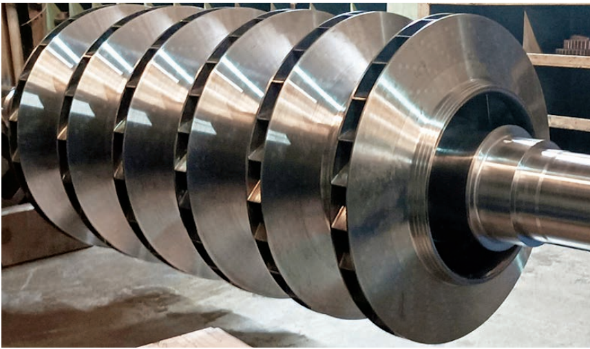
Рис. 5. Стальные рабочие колеса в клепаном исполнении
