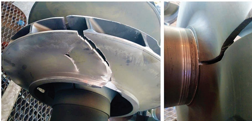
Рис. 1. Разрушение рабочего колеса из-за отклонений режима термообработки
