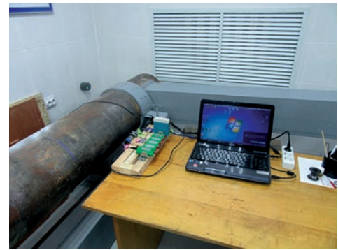
Рис. 5. Лабораторный стенд по исследованию напряженно-деформированного состояния трубопроводов
