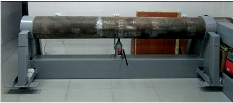
Рис. 5. Лабораторный стенд по исследованию напряженно-деформированного состояния трубопроводов
