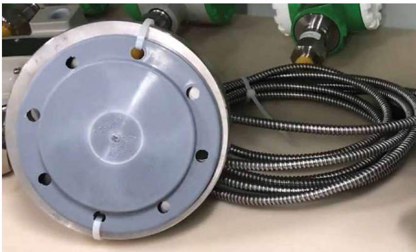
Фото 2. Выносная разделительная мембрана датчика давления с защитной заглушкой на присоединительной поверхности
