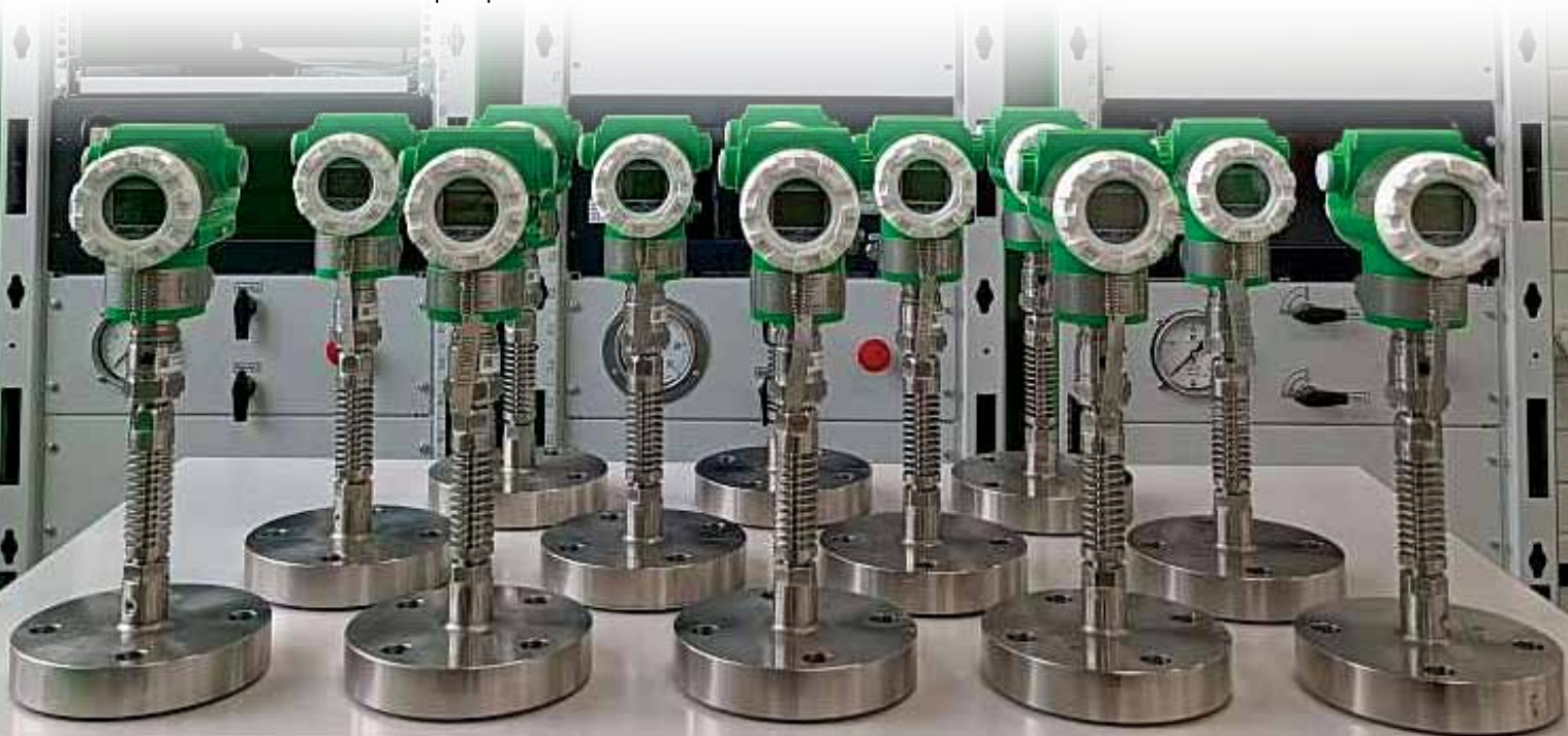
Фото 1. Датчики избыточного давления ЭМИС-БАР 173 с выносной разделительной мембраной и радиатором для высоких температур рабочей среды
