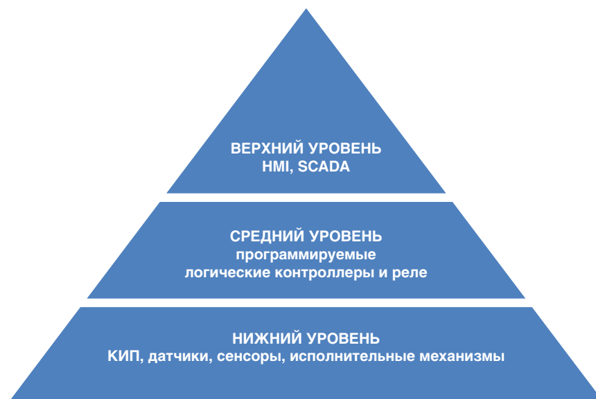
Рис. 1. Структурная схема АСУ ТП в виде пирамиды
