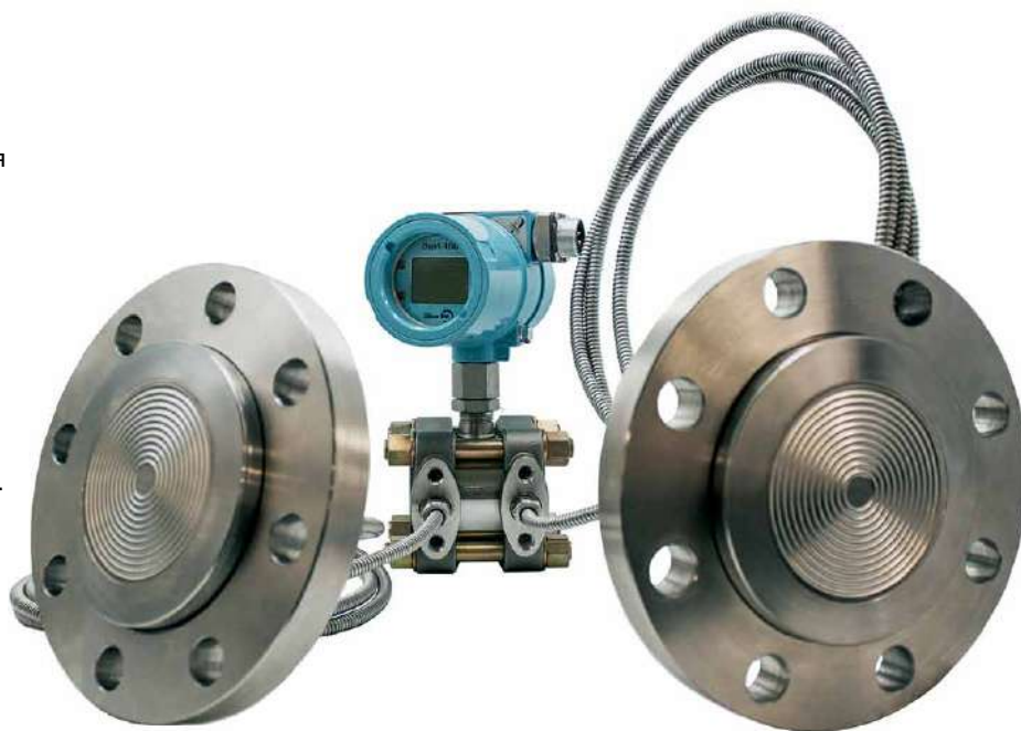
Рис. 1. Система с выносными мембранами для измерения уровня жидкости в резервуаре или расхода жидкости (газа) в трубопроводе
