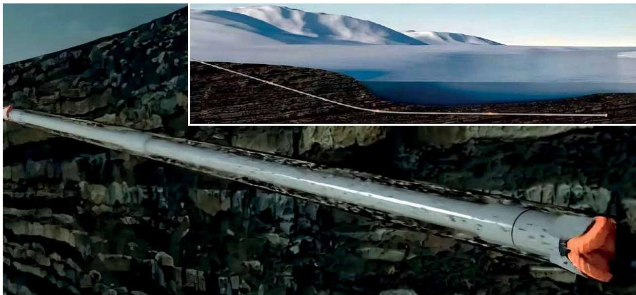
**Рис. 1.** Схема формирования пилотной скважины подземного перехода нефтегазопровода
