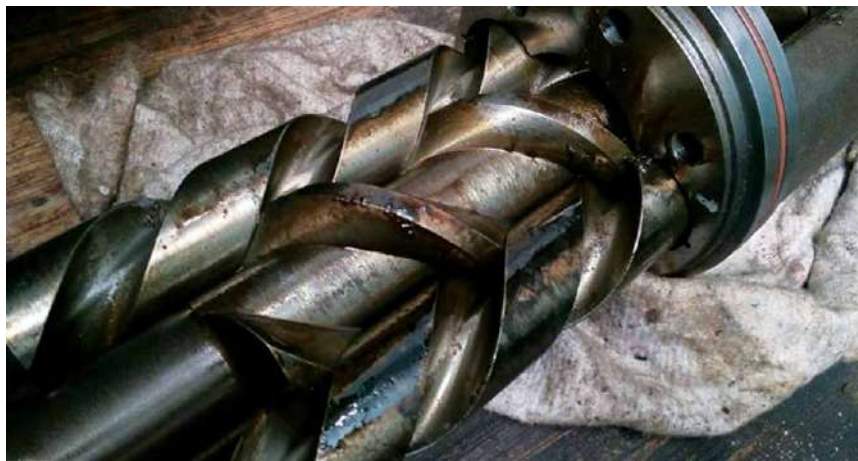
Рис. 3. Фото внешнего вида винтов неисправного насоса NETZSCH
