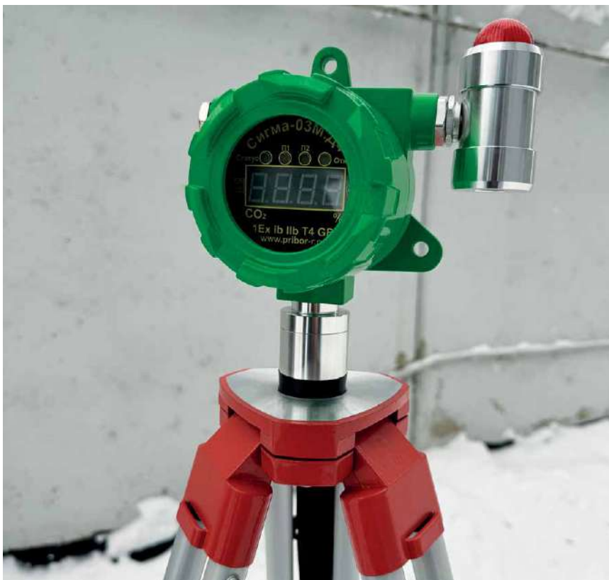
Рис. 2. Датчик Д4 в арктическом исполнении, установленный на объекте
