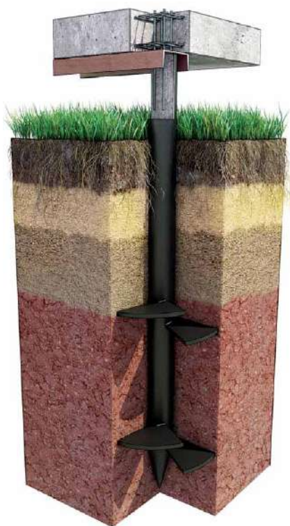
Рис. 6. Фрагмент постановки бетонной площадки на сваях в грунт
