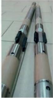
Резистивиметр – это геометрически скомпенсированный, двухчастотный (400 кГц и 1.8 МГц), двухзондовый скважинный прибор, предназначенный для измерения удельного сопротивления горных пород во время бурения скважины.
