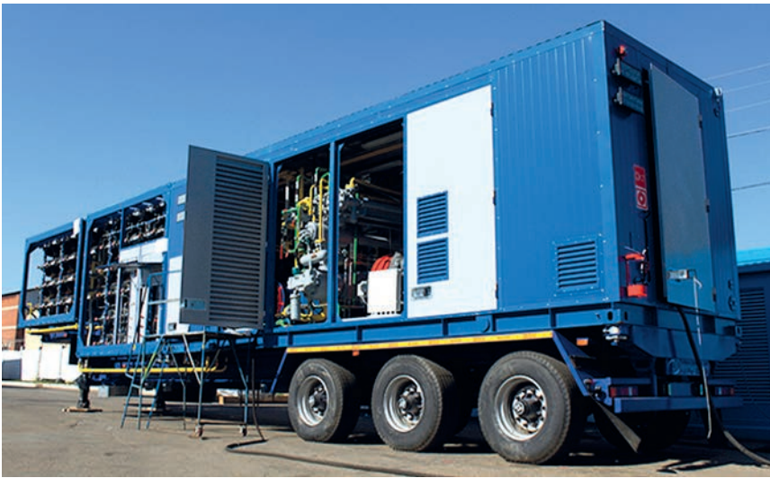
Фото 2. Испытания мобильной АГНКС на открытой площадке
