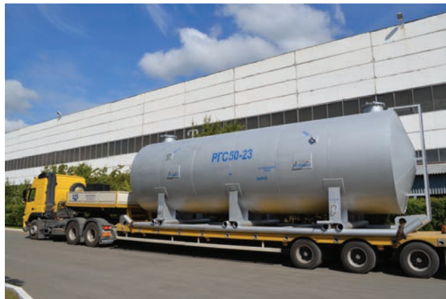
Резервуар горизонтальный стальной «РГС»
