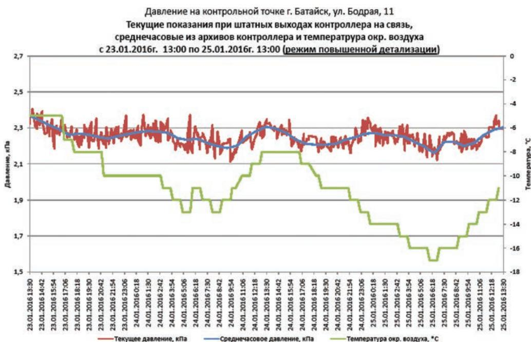
Интервальные архивные данные (усреднение за час), считываемые с контроллера в автоматическом режиме позволили увидеть закономерность динамики изменения давления от температуры окружающей среды и настроек регулятора на ПРГ.
