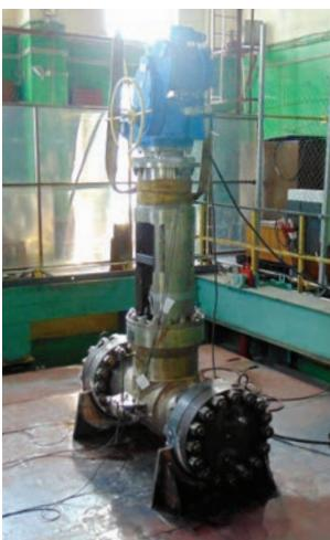
Сейсмоплатформа «УСВС-100»: испытания на сейсмостойкость вантуза нефтепровода (слева) и задвижки DN300 (справа)
