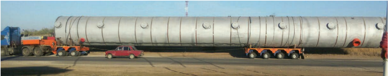
Перевозка 40-метровой колонны на модулях SPECPRICEP
