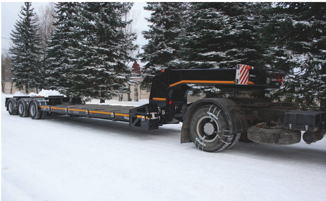
Сверхлегкий полуприцеп с отстегивающимся гусаком грузоподъемностью 30 тонн
