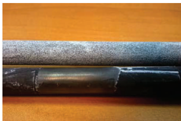
Рис. 7. Внешний вид поверхности анодов с оксидным покрытием и без покрытия после окончания эксперимента
