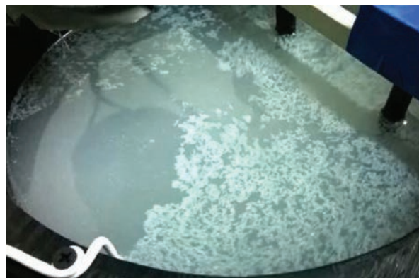
Рис. 6. Оксид титана на поверхности электролита, образующийся при испытании титанового анода без покрытия
