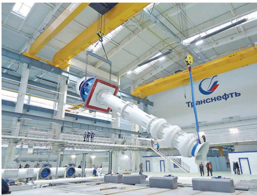
Рис. 2. Вертикальные подпорные насосы испытательного центра
