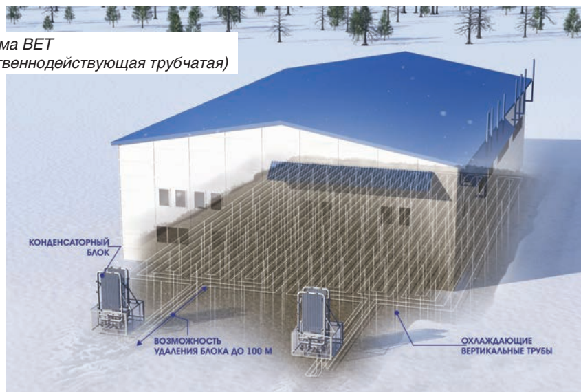
Охлаждающая система ГЕТ (горизонтальная естественнодействующая трубчатая)
