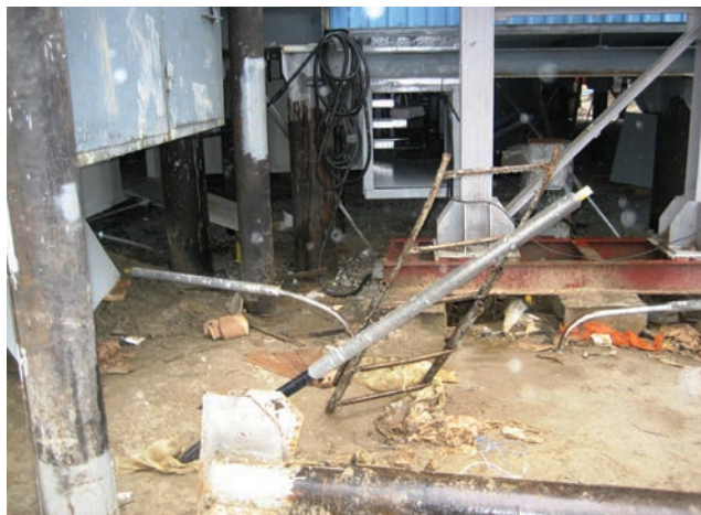
Рис. 5. Деформированные и вышедшие из строя термостабилизаторы на одной из ГКС
