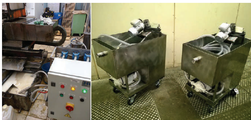
Установки для очистки СОЖ
