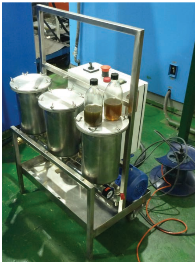
Установка ФКС-03(Б). Очистка трансмиссионного масла испытательного стенда на Петербургском тракторном заводе
