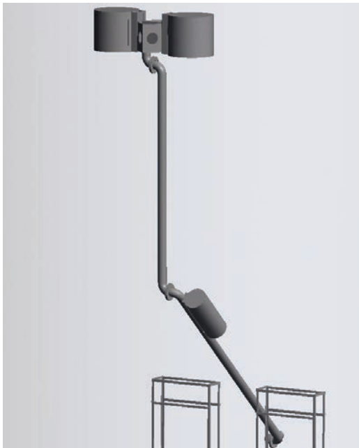
Понтонный скиммер с подвижной дренажной системой для резервуара с моноэтаноломином
