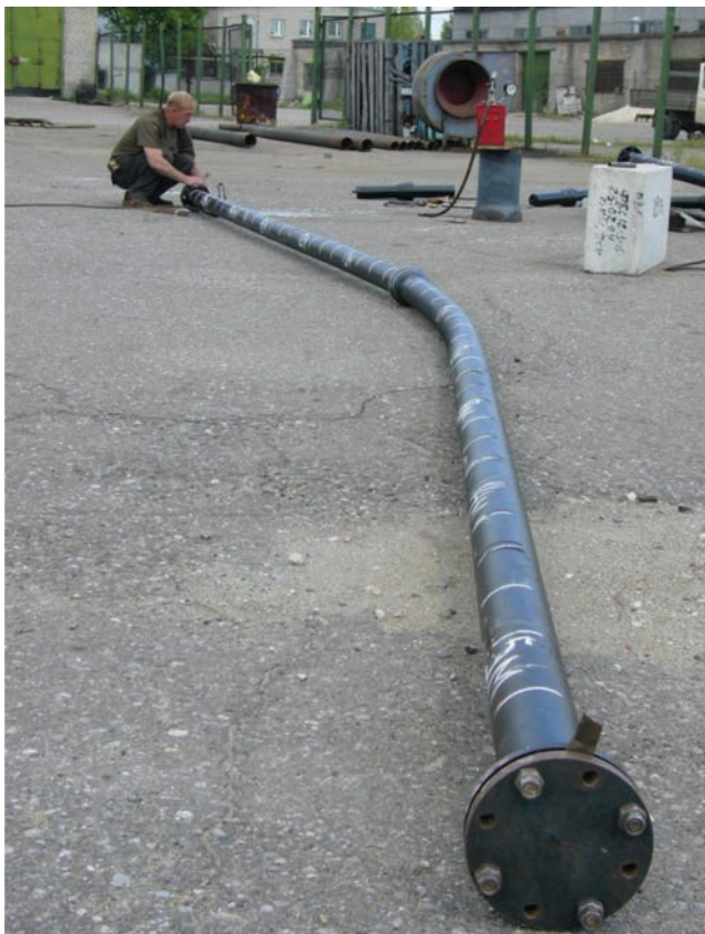
Рис. 5. Плеть с соединением «RJ» после испытаний на внутреннее давление с изгибом
