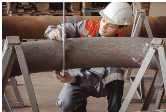
Выходной контроль готовых гнутых отводов
