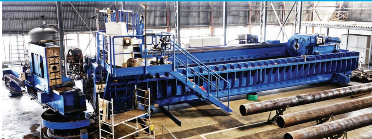
Индукционно-гибочный стан SRBMI 800 немецкой фирмы AWS SCHAFFER
