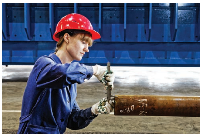
Приемка трубы, входной контроль
