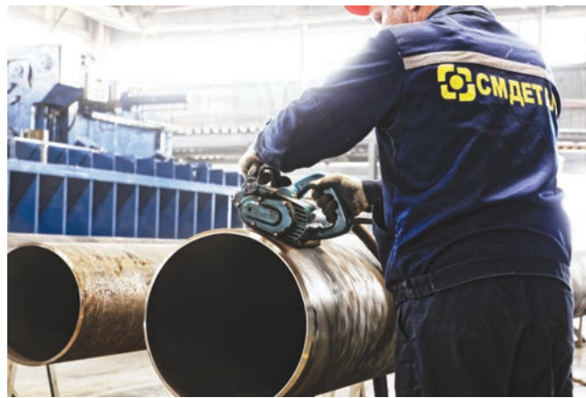
Подготовка трубы перед гнутьем
