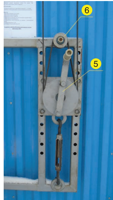
Рис. 2. Механизм привода устройства: 5 – барабан, 6 – обводной ролик
