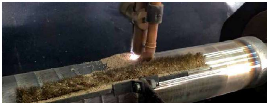
Рис. 4. Плазменная наплавка под флюсом
