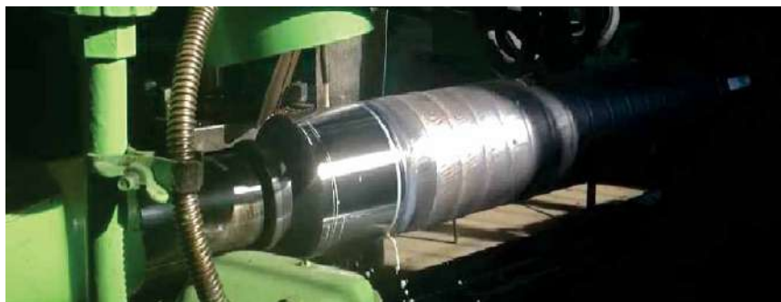
Рис. 5. Механическая обработка наплавленного покрытия
