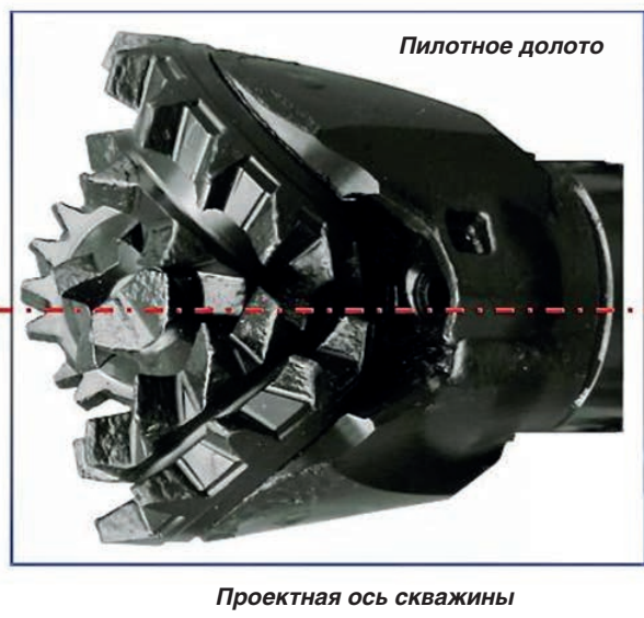
Рис. 2. Пилотное долото и шестишарошечный расширитель
