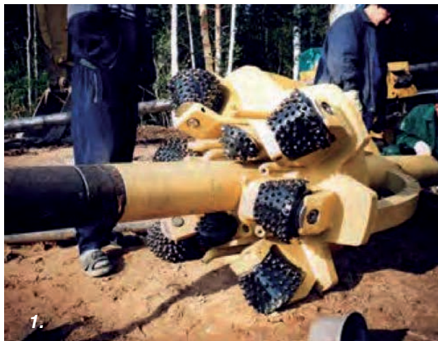
Рис. 3. Шарошечные расширители, используемые при ННБ: многоярусный для одноэтапного расширения (1) и одноярусный фирмы INROCK (2)
