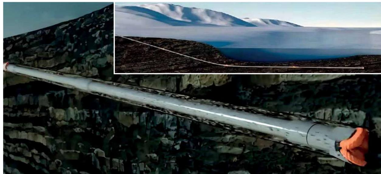
Рис. 1. Схема формирования пилотной скважины подземного перехода нефтегазопровода
