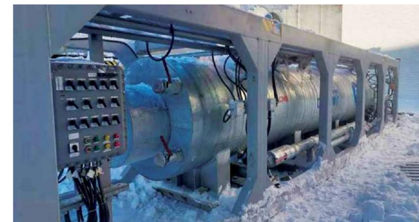
Рис. 2. Фото блока двухфазного сепаратора 12,5 м³ ОЙЛТИМ
