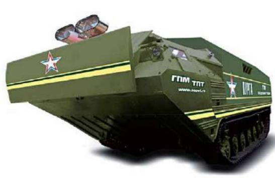
Гусеничный транспортер ПТС-2 твердопеноного пожаротушения
