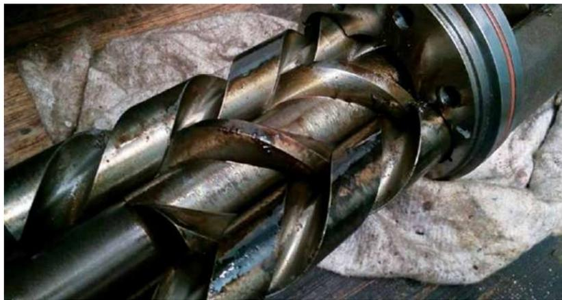
Рис. 3. Фото внешнего вида винтов неисправного насоса NETZSCH
