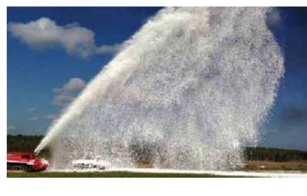
Подача пенных струй кратностью 30-40. Высота струи 40-45 м. Дальность струи 100 м
