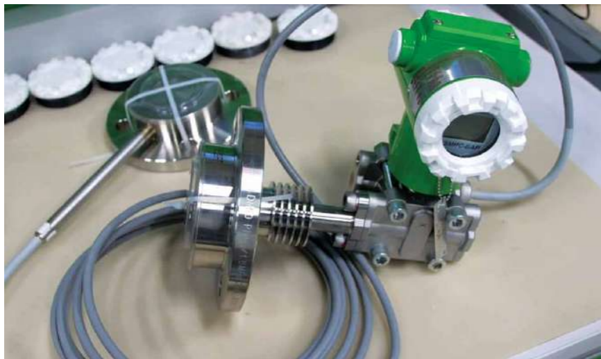
Фото 4. Датчик дифференциального давления ЭМИС-БАР 183 для измерения уровня в емкости под избыточным давлением. Фланцевое крепление в нижней части сосуда к плюсовой камере датчика и фланцевое крепление в верхней части сосуда для компенсации избыточного давления паровой фазы продукта.
