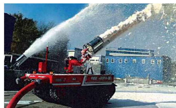
Роботизированный комплекс РКВХ Пурга-100 в действии
