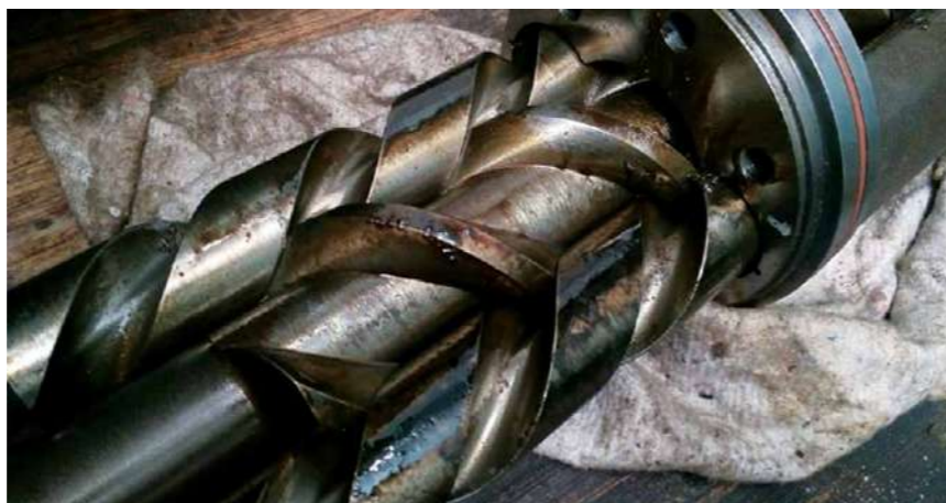
Рис. 3. Фото внешнего вида винтов неисправного насоса NETZSCH
