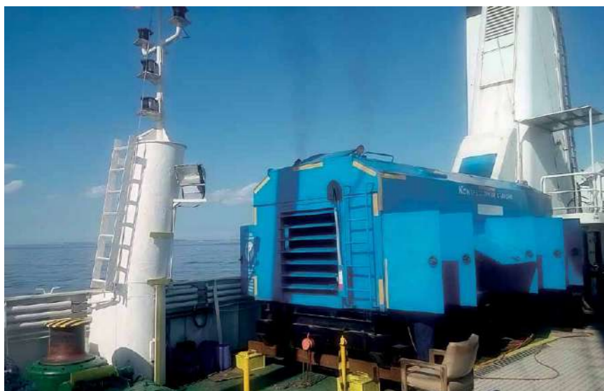
Компрессорная станция ТГА на судне
