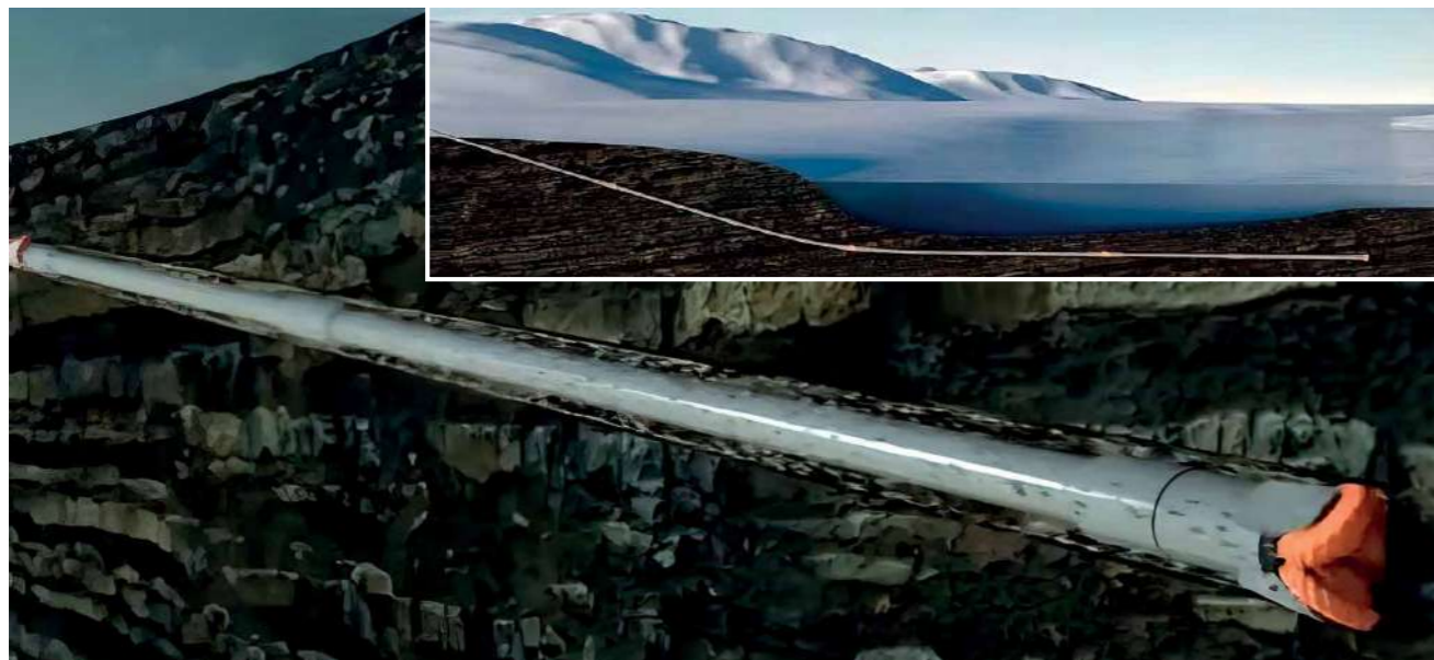
Рис. 1. Схема формирования пилотной скважины подземного перехода нефтегазопровода
