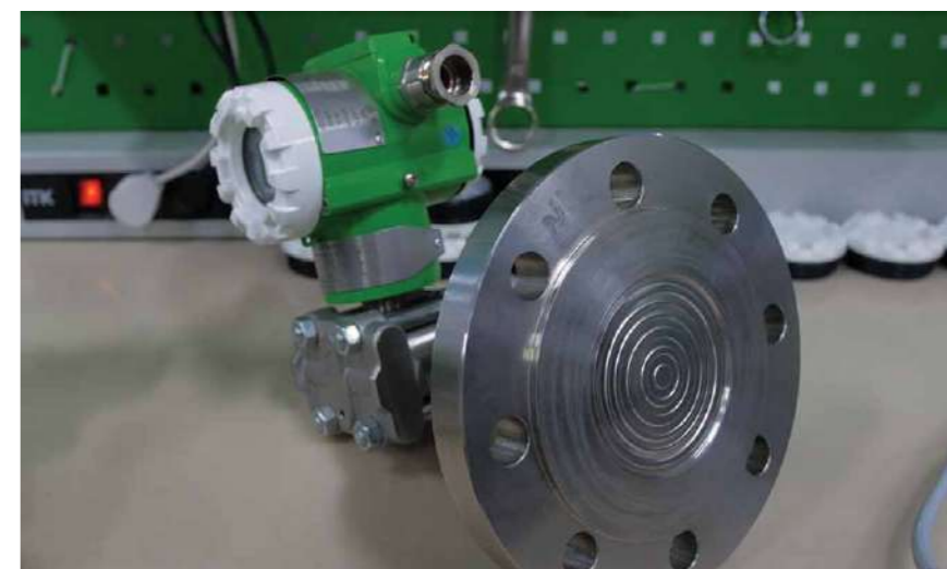
Фото 3. Датчик гидростатического давления ЭМИС-БАР 163 для измерения уровня жидкости в емкости с фланцевым присоединением
