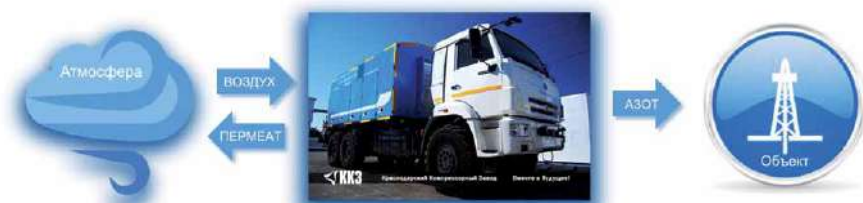
Рис. 2. Схема процесса получения газообразного азота из воздуха
