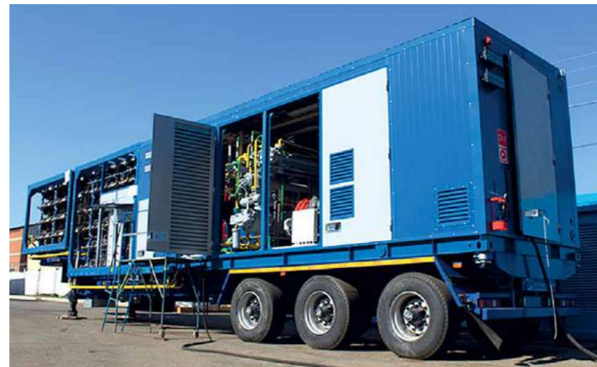
Фото 2. Испытания мобильной АГНКС на открытой площадке
