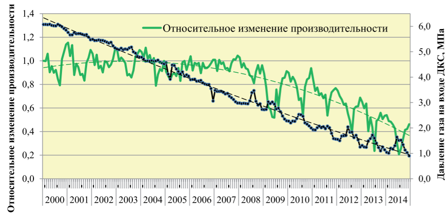
Рис. 6. Графики абсолютного давления газа на входе ДКС и относительного изменения производительности ДКС
