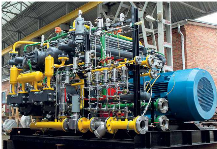
Фото 1. Компрессор для АГНКС метановый (для сжатия метана) 4ГМ2,5-2,38/7-251 производства ККЗ
